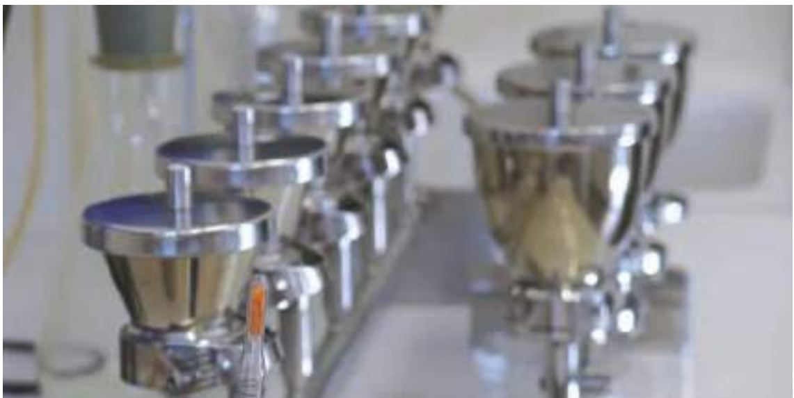
Laboratoire de bactériologie // Rampes de filtration pour l'analyse microbiologique de l'eau
